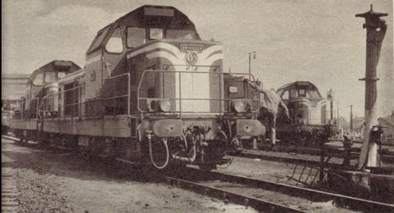
Les BB 66000 en U.M. se substituent progressivement aux 141 R en double traction. (Cl. O. Perrelle.)
